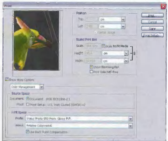
Рис. 2. Окно Print with preview программы Adobe Photoshop CS, где указывается цветовое пространство источника и профиль устройства вывода.
