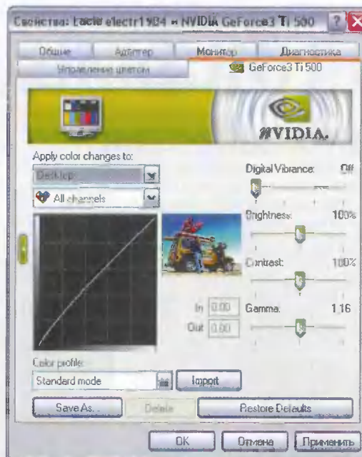
Рис. 4. Для достижения нужного значения Gamma воспользуйтесь ползунком гамма-коррекции в драйвере.
